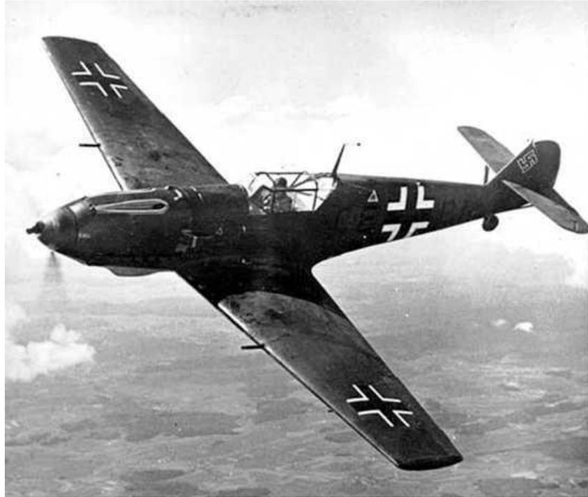
**Sur ce Messerschmitt Bf 109 E, familièrement appelé Emil, on distingue nettement les 2 mitrailleuses de capot et les canons de 20 mm dans les ailes.**
